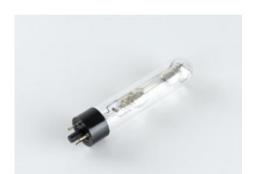
Lampe au sodium pour polarimètre (657590 et 657591)
