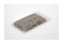
Pour éviter la distorsion d'ébullition lors du chauffage de solutions aqueuses.
