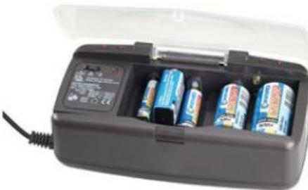
Avec fonction de décharge et de vérification de capacité (test). Pour piles rechargeables de type Mono (D), Baby (C), Mignon (AA), Micro (AAA) et piles de 9 volts. Modes de fonctionnement : charge, décharge (afin d'éviter l'effet mémoire pour les accus NiCd), fonction de test de l'accu (témoin lumineux). Quatre stations, deux raccords de 9 V. Affichage de l'état de charge par LED.
