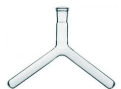
Tube de réaction à 2 branches, diam. col 19, 110 mm
