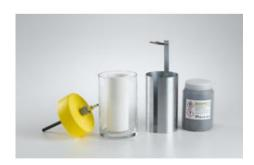
Pour la démonstration du principe de fonctionnement d'une pile saline ou pile sèche charbon-zinc. Démontable, à remplir avec une solution de chlorure d'ammonium à 20 %.
