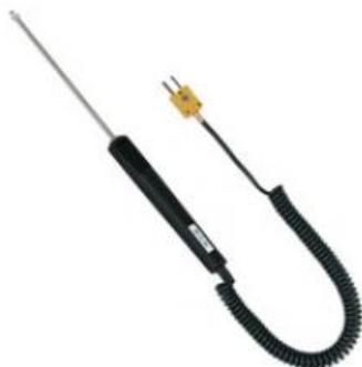
Thermocouple NiCr-Ni avec connecteur miniature pour la mesure de la température sur des surfaces solides, avec poignée et câble spiralé. S'utilise avec CASSY, combiné au connecteur adaptateur NiCr-Ni S (524 0673), ou directement avec l'adaptateur chimie (524 067) et le Mobile CASSY 2 (524 005).
