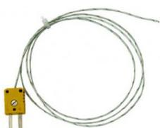
Thermocouple NiCr-Ni avec connecteur miniature pour la mesure très rapide dans l'air, les gaz et les liquides, isolé soie de verre, sans poignée. S'utilise avec CASSY, combiné au connecteur adaptateur NiCr-Ni S (524 0673), ou directement avec l'adaptateur chimie (524 067) et le Mobile CASSY 2 (524 005).
