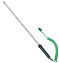
Thermocouple NiCr-Ni avec connecteur miniature, sonde extra longue pour la mesure par ex. dans du compost, avec poignée et câble spiralé. S'utilise avec CASSY, combiné au connecteur adaptateur NiCr-Ni S (524 0673), ou directement avec l'adaptateur chimie (524 067) et le Mobile CASSY 2 (524 005).
