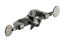
Pour la fixation à angle droit et en parallèle de tubes et de tiges.
