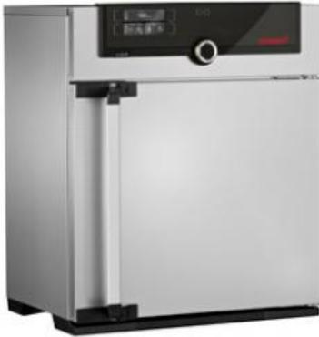
Modèle à convection naturelle tout en acier inoxydable (panneau arrière en tôle d'acier galvanisé) avec rainures périphériques embouties intégrant sur une grande surface les corps de chauffe sous manchon céramique. Tableau à commandes intuitives SingleDISPLAY (affichage graphique couleur) à écran tactile ; porte inox entièrement isolée. Minuterie digitale avec programmation de l'heure d'arrêt et réglage de la durée de 1 minute à 99 jours.
