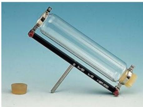
En verre, avec tige et douilles de raccordement pour fiches de 4 mm. Filament chauffant pour basse tension à l'intérieur du tube. Exemples d'application : Détermination de la masse moléculaire selon Victor Mayer Lois des gaz de Gay-Lussac
