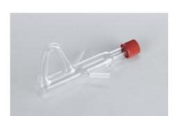
Appareil pour détermination du point de fusion de
