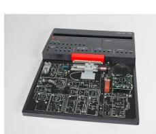
Le cours COM4LAB « Capteurs » comprend les bases et les notions fondamentales de la technique des capteurs. Le fonctionnement des capteurs typiques est expliqué et mis en pratique à l'aide d'un grand nombre d'expériences. Ce cours se compose de 10 chapitres.
