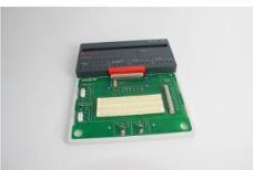
La plaque d'essai II ou carte de prototypage (protoboard) fait de l'unité centrale COM4LAB un environnement de développement pour les circuits électroniques.
