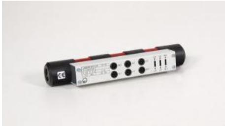
Chariot mobile avec trois bobines monté sur roulements à billes, bornes des bobines avec douilles de sécurité 4 mm.
