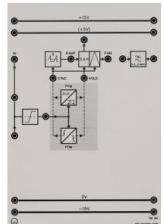
Le démodulateur PTM (MIT) reconvertis les modulations d'impulsions dans le temps PPM (MIP) et PDM (MID) en PAM (MIA).
