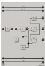
A partir du signal modulant, il est généré une modulation d'impulsions en durée PDM par le pas intermédiaire de l'échantillonnage (établissement d'une PAM(MIA)) selon le procédé des impulsions en dents de scie.
