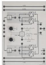
La modulation d'impulsions en amplitude (PAM) est réalisée par échantillonnage d'un signal analogique.
