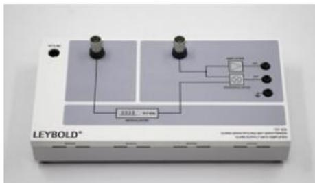
L'alimentation Gunn fournit la tension d'alimentation nécessaire au fonctionnement de l'oscillateur Gunn et amplifie les signaux faibles reçus de la sonde de champ électrique.
