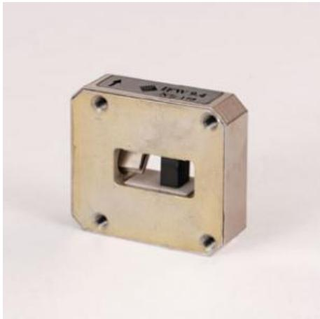
La ligne unidirectionnelle est un composant non réciproque de la technique des micro-ondes. Alors que l'affaiblissement de l'onde hyperfréquence est pratiquement inexistant dans un sens, il est très important dans le sens opposé. Cet isolateur travaille selon le principe de déplacement du champ et est utilisé en particulier pour découpler l'oscillateur du reste du dispositif de mesure.
