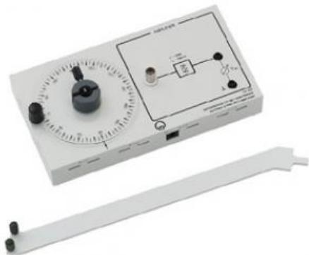
Cet appareil sert de socle pour les antennes dipôles, Yagi et helicoidal lors du relevé de diagrammes de directivité. La position angulaire de l'antenne est définie manuellement et peut être relevée sur un disque tournant pourvue d'une échelle angulaire. Le signal de l'antenne testée est reçu et amplifié par un amplificateur sélectif en fréquence qui l'amène à un niveau facile à exploiter.
