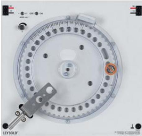
Remplace le moteur pour tous les systèmes à distribution d'allumage statique et à injection diesel électronique avec dispositif d'installation pour le capteur CPS de la vitesse et de la position du vilebrequin et pour le capteur de PMH d'atelier pour la détermination du point d'allumage.
