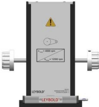
Entraînement par courroie pour basculer entre le moteur pour les tests de générateur 1,0 kW 7386311 et le générateur compact Kfz 7387111 pour augmenter la vitesse du générateur aux valeurs typiques pour les véhicules.
