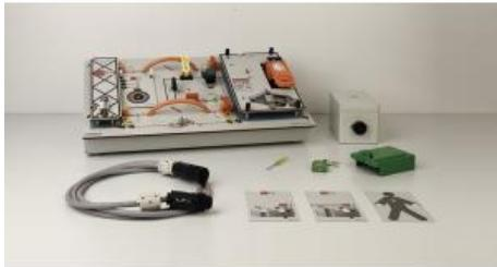
Ce poste de travail haute tension met à disposition un environnement d'apprentissage pour la formation haute tension en trois étapes selon la norme allemande DGUV.
