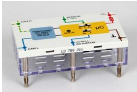
N?ud de bus CAN éducatif en tant qu'élément enfichable pour détecter un signal de capteur et générer un signal d'actionneur.
