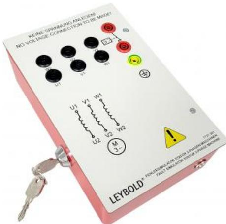
Le simulateur de défauts permet, en combinaison avec les moteurs asynchrones triphasés à cage d'écureuil, de simuler des défauts typiques tels que le défaut à la terre, l'interruption de l'enroulement, le défaut de spire, le défaut d'enroulement et la réponse du thermocontact.
