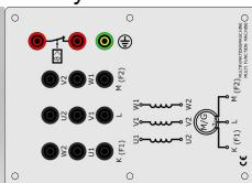
Machine multifonctions triphasée, peut être utilisé comme moteur à bague collectrice ou comme machine synchrone pour le fonctionnement du moteur et du alternateur.
