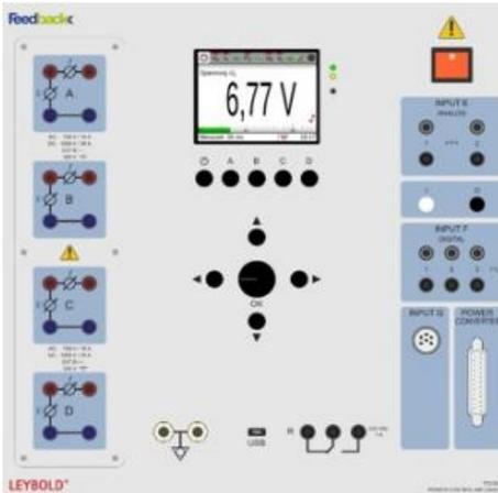
Le Power Control CASSY est l'appareil de commande universel pour la technique énergétique. Il peut aussi bien alimenter des réseaux isolés que réinjecter de l'énergie dans le réseau électrique. Il peut servir de centrale électrique conventionnelle et même de dispositif de stockage d'énergie. Il est principalement destiné à l'alimentation en électricité de consommateurs à partir de sources d'énergie renouvelables.
