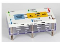
N?uds de bus CAN éducatif en tant qu'élément enfichable pour détecter un signal de capteur et générer un signal d'actionneur.
