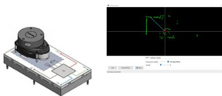
L'élément enfichable est utilisé pour les circuits construits sur les cartes enfichables DIN A4 ou DIN A3. Avec ce module, les bases de la détection d'obstacles peuvent être examinées à l'aide de systèmes optiques à laser.
