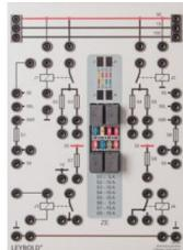
La Centrale électrique (ZE) est un module électrique centralisé dans lequel des parties du câblage d'automobile sont réunies pour fusionner des composants (bloc de fusibles) ou des relais de commutation. Il est utilisé pour la distribution centrale de la tension de batterie borne 30 et la tension connectée à la borne d'allumage borne 15 avec le contrôle d'éclairage conventionnel.
