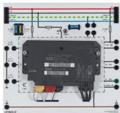
Original unit de commande d'automobile pour l'évaluation du commutateur des feux marche arrière et pour connecter un dispositif de test de diagnostic automobile (z. B. 7379803) via la prise OBD 738975 le système d'éclairage automobile avec bus CAN, 738111.
