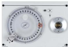
Remplace un moteur, avec volant d'inertie et arbre à cames, pour les systèmes d'allumage à distributeur (SZ, TZ-I, TZ-H), sans distributeur (DIS) et Motronic.
