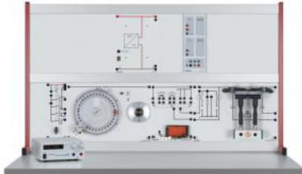
La bobine crayon unitaire est une unité compacte constituée de la bobine et d'une bougie d'allumage. Un côté de l'enroulement secondaire est à la masse, l'autre côté est directement branché à la bougie. Il n'est ainsi plus possible de connecter un capteur de tension capacitif à la ligne d'alimentation de la bougie. La plaque d'enseignement « Système d'allumage à bobines crayons unitaires » est donc dotée de deux sorties de mesure afin de pouvoir enregistrer l'oscillogramme secondaire.
