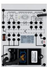
Calculateur de gestion de la cartographie pour système d'allumage par bobine jumo-statique (sans distributeur DIS) ou par bobine crayon (EFS).
