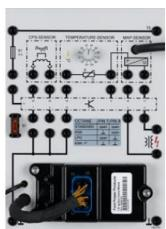
Calculateur de gestion de la cartographie pour système d'allumage par bobine jumo-statique (sans distributeur DIS) ou par bobine crayon (EFS).
