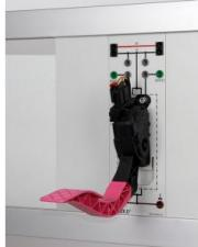
Capteur de pédale d'accélérateur d'origine moderne avec interface SENT (Single Endedibble Transmission) selon SAE J2716 TM et résistance de rappel intégrée pour une expérimentation facile. L'interface SENT du capteur de pédale d'accélérateur prend en charge le mode de canal rapide pour la sortie des positions au format sécurisé 12 bits et le canal lent pour la sortie de données supplémentaires.
