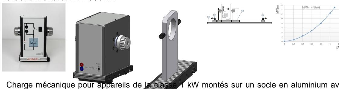
Charge mécanique pour appareils de la classe 1 kW montés sur un socle en aluminium avec deux extrémités d'arbre.
