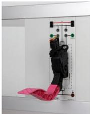
Capteur de pédale d'accélérateur d'origine moderne avec interface SENT (Single Edge Nibble Transmission) selon SAE J2716 TM et résistance de rappel intégrée pour une expérimentation facile. L'interface SENT du capteur de pédale d'accélérateur prend en charge le mode de canal rapide pour la sortie des positions au format sécurisé 12 bits et le canal lent pour la sortie de données supplémentaires.
