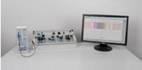
« SENT » (Single Edge Nibble Transmission) est une interface pour l'échange rapide de données entre un capteur ou un actionneur et un ordinateur.
