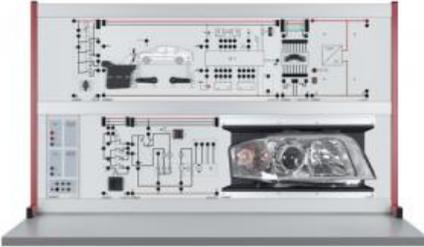
Le législateur exige une correction automatique de la portée déclairement pour les phares au xénon. Ce système d'apprentissage avec simulation intégrée de l'accélération et du freinage (commutable) comprend une correction automatique et dynamique de la portée déclairement en vue de compenser les variations de la hauteur de caisse et donc de l'inclinaison de l'axe du faisceau lumineux produit par les phares d'un véhicule.
