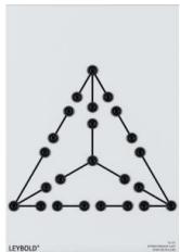
Plaque enfichable pour le montage de charges pour génératrices à l'aide des éléments enfichables du système STE en configuration étoile ou triangle.
