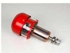
Rotor pour machine asynchrone triphasée avec cage en cuivre sous la forme d'un modèle de travail démontrant un fonctionnement efficace, avec bouclier non entraîné.
