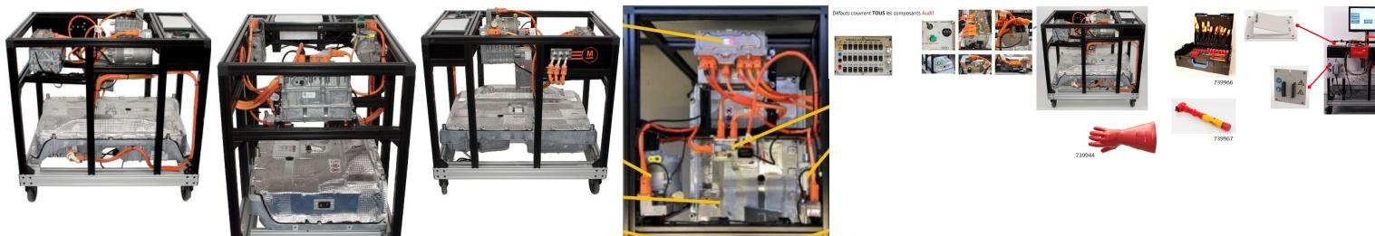
Le système offre un aperçu de tous les composants HV facilement accessibles, provenant d'un véhicules : batterie, câbles, chauffage, climatisation, l'électronique de puissance. Les travaux nécessaires à la consignation peuvent être effectués à l'identique du véhicule dans des conditions plus simples.
