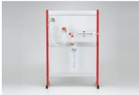
L'expérience C1.1.1.1 consiste à déterminer la masse molaire de certains métaux communs. Ceux-ci, par ex. le magnésium, sont mis en réaction avec de l'acide.
