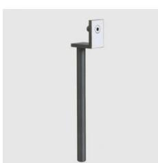
Pour positionner une fibre en verre ou en plastique sur le banc d'optique.
