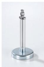
Pince à ressort fixée sur un aimant. Pour la réalisation de montages expérimentaux en chimie sur les tableaux magnétiques ( 666 4659 et 666 4660 ). Peut être utilisé avec tous les modules CPS. Maintient des éléments de 9 à 11 mm de diamètre, par ex. des tubes en verre.
