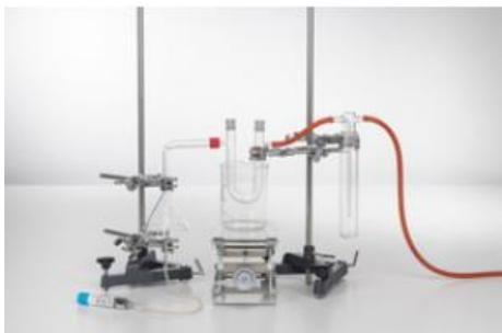
Dans l'expérience C1.3.2.1, on brûle de l'hydrogène.
