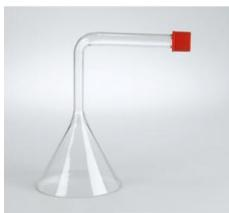
Entonnoir spécial en verre borosilicaté pour la collecte des gaz. Thermostable pour collecter les gaz de combustion, par ex. lors de la combustion du soufre ou de l'hydrogène.
