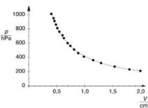
Pour étudier le comportement thermique des gaz (dilatation, augmentation de la pression), aborder la notion d'échelle des températures absolues et déterminer le zéro absolu. Tube capillaire ouvert à une extrémité, contenant un volume de gaz variable fermé par une gouttelette de mercure.
