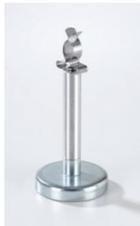
Pince à ressort fixée sur un aimant. Pour la réalisation de montages expérimentaux en chimie sur les tableaux magnétiques ( 666 4659 et 666 4660 ). Peut être utilisé avec tous les modules CPS. Maintient des éléments de 11 à 14 mm de diamètre, par ex. les raccords RN 14 et GL 14.
