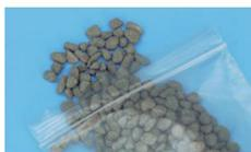
Pour éviter la distorsion d'ébullition lors du chauffage de solutions aqueuses.
