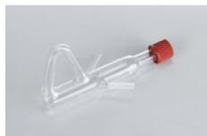
Appareil en verre, simple, pour la mesure de points de fusion, avec raccord fileté GL 18 pour le thermomètre et deux tubulures latérales.
