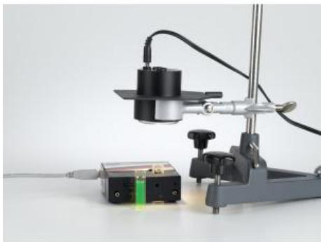
Dans l'expérience C3.3.1.3, la solution du colorant fluorescent fluorescéine est éclairée avec la lumière d'une lampe à incandescence.
