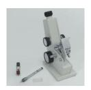
Permet la mesure des indices de réfraction d'échantillons liquides et solides pour une lumière de longueur d'onde ?= 589,3 nm ainsi que la détermination de la dispersion moyenne, avec échelle de la teneur en sucre, dispositif d'éclairage, étalon avec indice de réfraction, flacon avec liquide de contact, thermomètre et clé d'ajustage.
