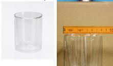
Calorimètre de demonstration pour la détermination des enthalpies de dissolution et de neutralisation. Récipient en verre à double paroi, sous vide, transparent et à fond plat pour la réalisation d'expériences sur l'agitateur magnétique.
