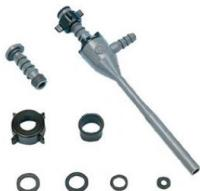
Pour les expériences dans le vide grossier. La pression finale qu'il est possible d'obtenir dépend de la température de l'eau. Clapet de non retour pour empêcher le reflux d'eau. En plastique, démontable.
