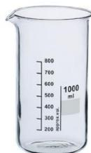
Forme haute, avec bec verseur, ISO 3819, DIN 12331
